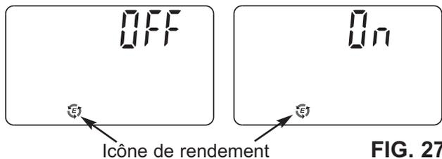
**RENDEMENT DU SEL** : Lorsque cette fonction est ACTIVÉE, l'appareil fonctionne à une capacité de 4 000 grains de dureté par livre de sel ou plus. L'adoucisseur peut se régénérer plus souvent en utilisant moins de sel et d'eau. Cette fonction a été DÉSACTIVÉE en usine. Appuyez sur les boutons  $\Delta$  HAUT ou  $\nabla$  BAS pour choisir entre ARRÊT et MARCHE.
