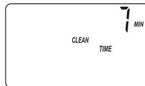
**DURÉE DE LA FONCTION DE NETTOYAGE** : Si vous avez activé la fonction de nettoyage, la durée du cycle de lavage à contre-courant est automatiquement réglée sur une valeur par défaut qui dépend du modèle. Cette durée peut être réglée de 1 à 15 minutes. Si vous désirez modifier la durée de ce cycle, appuyez sur le bouton  $\Delta$  HAUT pour l'allonger ou  $\nabla$  BAS pour le raccourcir. Si aucun changement n'est souhaité, passez à l'étape suivante.
