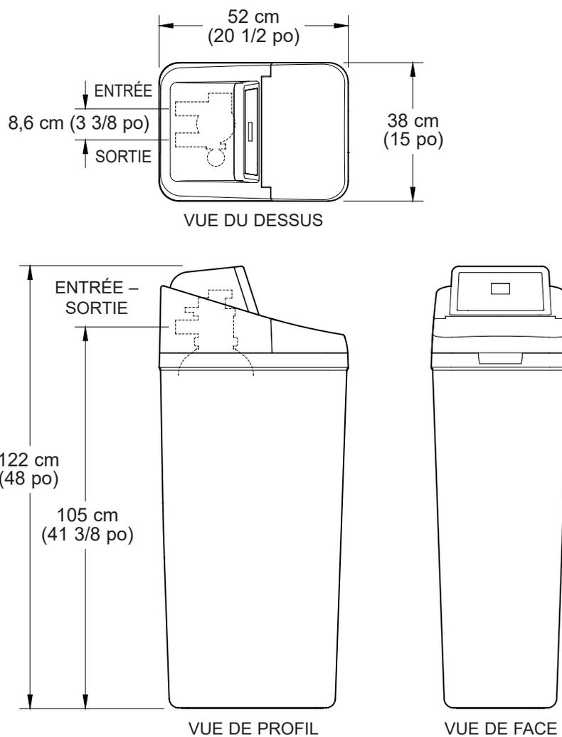
**REMARQUE :** En raison de variations dans la production et l'assemblage, la hauteur de la vanne d'adoucisseur d'eau peut varier jusqu'à 1/2 po, et peut ne pas correspondre aux systèmes précédemment installés. Cela n'affectera pas les performances du système.
