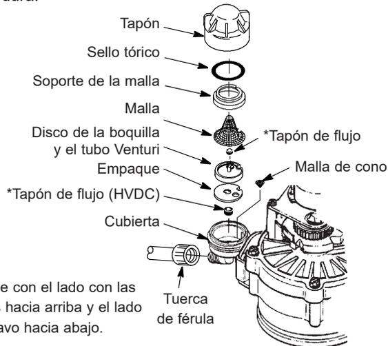
**IMPORTANTE:** Asegúrese de que el orificio pequeño del empaque se centre directamente sobre el orificio pequeño de la cubierta de la boquilla y del tubo Venturi. Asegúrese de que los números estén mirando hacia arriba.
