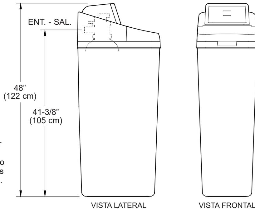
**NOTA:** Debido a variaciones en la producción y el ensamblaje, la altura de la válvula del ablandador de agua puede variar hasta en 1/2", y puede no coincidir con los sistemas instalados anteriormente. Esto no afectará al rendimiento del sistema.
