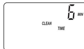
**DURÉE DE LA FONCTION DE NETTOYAGE** : Si vous avez activé la fonction de nettoyage, la durée du cycle de lavage à contre-courant est automatiquement réglée sur une valeur par défaut qui dépend du modèle. Cette durée peut être réglée de 1 à 15 minutes. Si vous désirez modifier la durée de ce cycle, appuyez sur le bouton  $\Delta$  HAUT pour l'allonger ou  $\nabla$  BAS pour le raccourcir. Si aucun changement n'est souhaité, passez à l'étape suivante.
