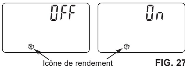
**RENDEMENT DU SEL** : Lorsque cette fonction est ACTIVÉE, l'appareil fonctionne à une capacité de 4 000 grains de dureté par livre de sel ou plus. L'adoucisseur peut se régénérer plus souvent en utilisant moins de sel et d'eau. Cette fonction a été DÉSACTIVÉE en usine. Appuyez sur les boutons  $\Delta$  HAUT ou  $\nabla$  BAS pour choisir entre ARRÊT et MARCHÉ.
