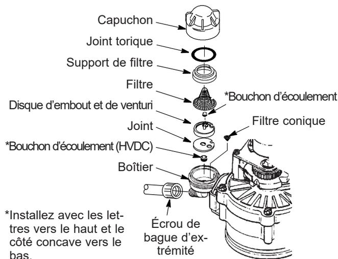
**IMPORTANT :** Assurez-vous que le petit orifice dans le joint est directement centré sur le petit orifice du boîtier de l'embout et du venturi. Assurez-vous que les nombres sont sur le dessus.
